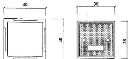
POZZETTO: Cemento armato vibrato.
